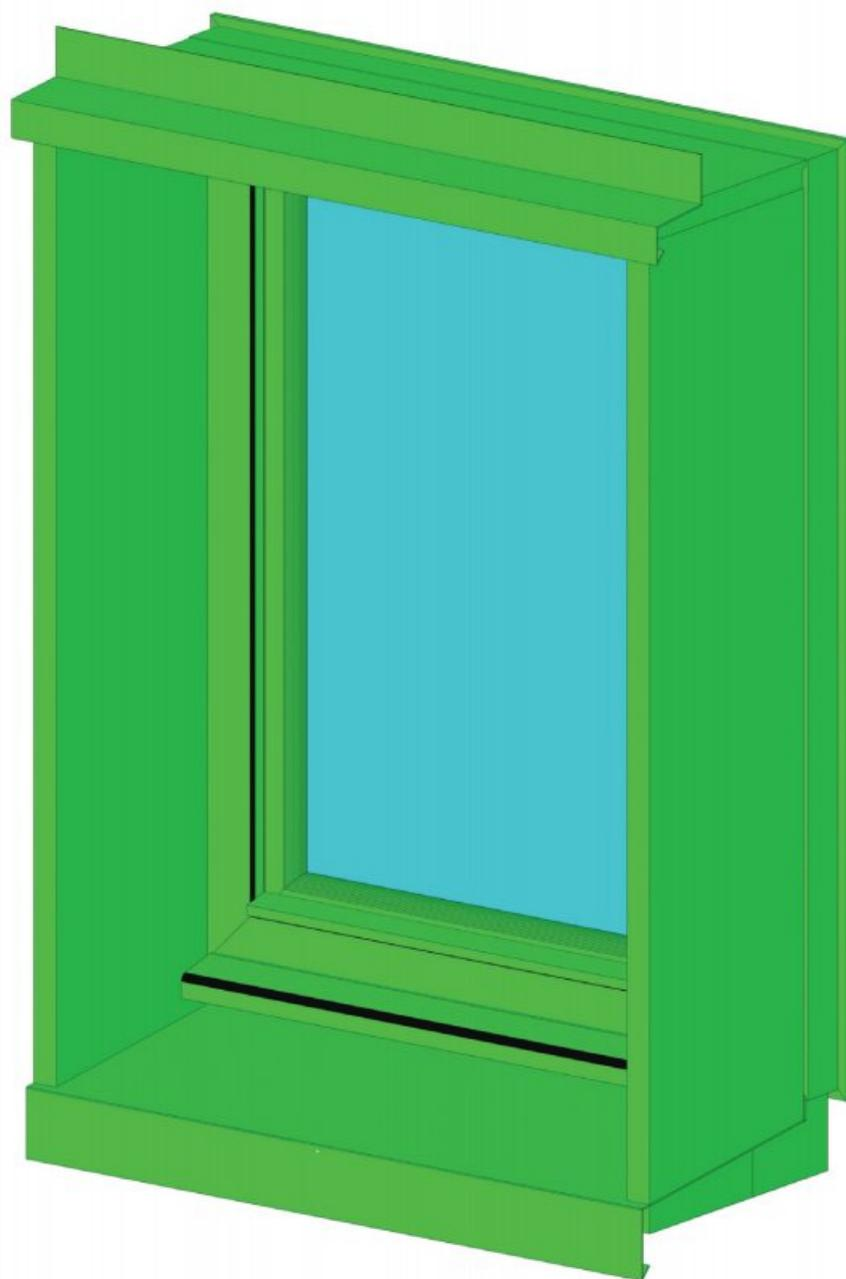
▲ Figure 2 : Fenêtre avec encadrement de baie intégré en usine
